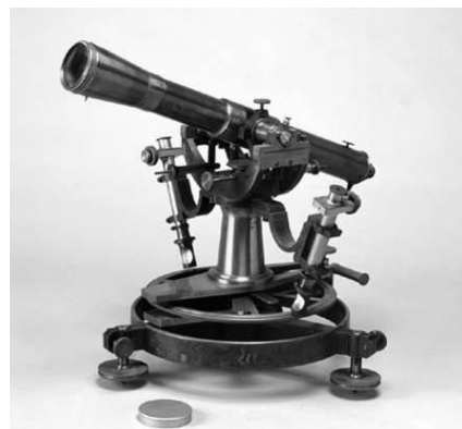
図 11-2-4 カールバンベルヒ (Carl Bamberg) 社製 一等経緯儀 (国土地理院蔵)
