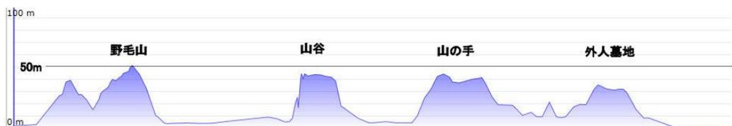
横浜地図測量史跡巡りコースの縦断面図
