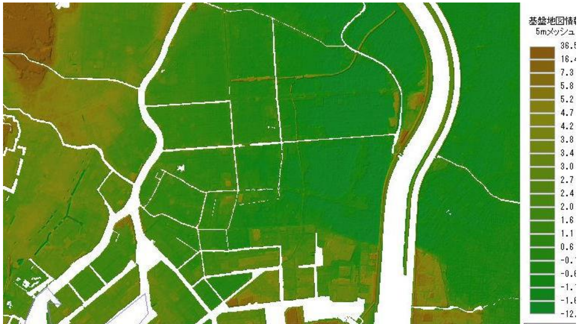
江東区周辺の1/25,000地形図とデジタル標高地形図 海岸に近い新しい埋め立て地や、河川周辺の標高が高い
