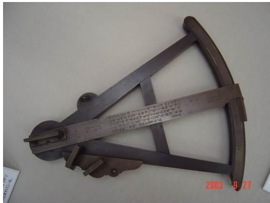
「トランスバサール（対角線）法とバーニア法」
