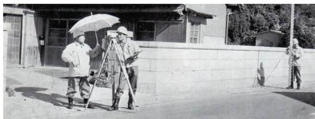
図 水準測量観測のようす（「測量・地図百年史」より）
