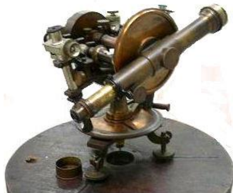
当時使用されたカールバンベルヒ三等経緯儀 (「国土地理院」蔵)
