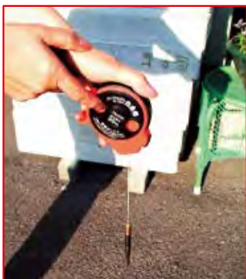
垂球付巻取器 30m (細長垂球 9φ×120mm 付)
