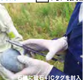
石礫に磁石+ICタグを封入
