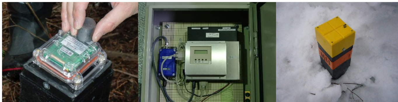
図-1 無線センサ端末 (マグネットスイッチによる起動状況)
