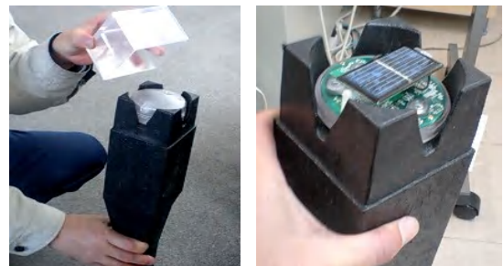
写真-2 杭に装着した状態
